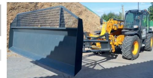
Nástavec pro teleskopický nakladač na kopání obilí, siláže, štěpky, sněhu
