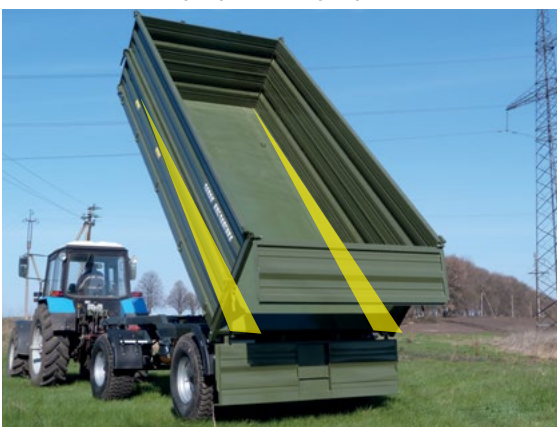
Kónická korba zabraňuje ulpění zelené hmoty a hnojiv
