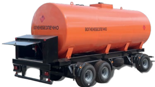
Plnicí nádrž na naftu
