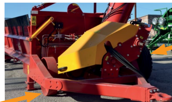
Možnost přidavných předních kol pro přepravu zrna v násypce stroje BNP
