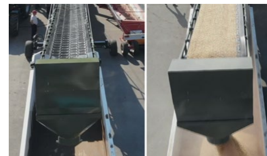
Ševronový pás ve tvaru V 1200 mm nepoškozuje semena
