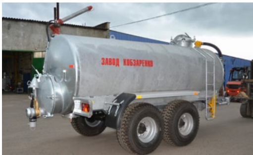
Žárové zinkování. Galvanizační vrstva 100-300 mikronů
