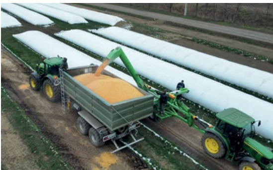
Vykládání obilí z pytle pomocí ZRM-180
