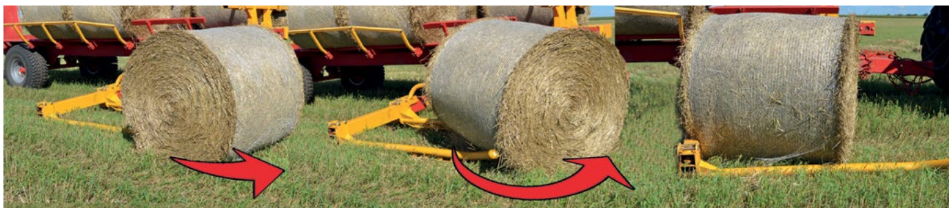
Univerzální hydraulické rameno naloží na poli balík a naloží na plošinu
