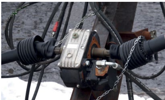
Vlastní hydraulický okruh ZRM-180. Pro zvýšení průtoku oleje na hydromotor
