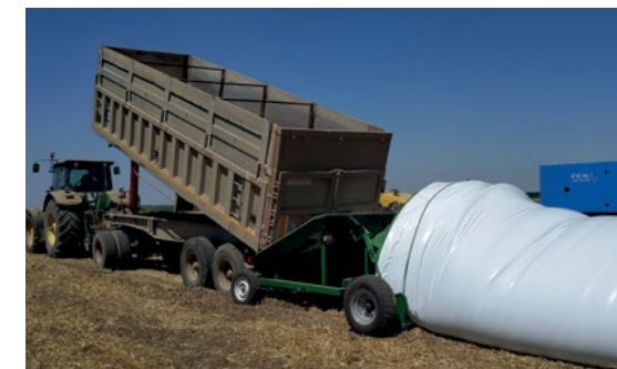
ЗПМ (А) -180 с нисък бункер и електродвигател. Зареждане от автомобил (камион).
