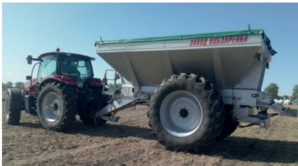
Разпръсквач на минерални торове за работа на технологичен габарит
