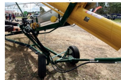
Допълнителна опция: механизъм за завъртане на задните колела
