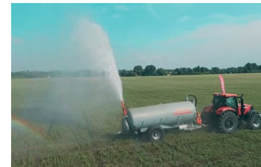
Хидро пистолет за напояване и повърхностно торене, пожарогасене
