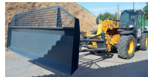
Удължител за телескопичен товарач за огребване на зърно, силаж, дървесен чипс, сняг
