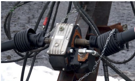
Автономна маслена станция на ЗРМ-180. За увеличаване на потока масло върху хидравличния мотор
