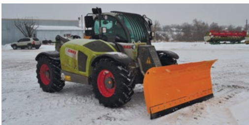
Гребло за сняг за телескопичен товарач VS-2400
