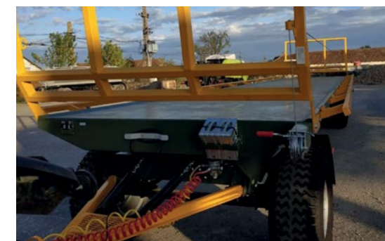
Лебедка и разширяване на платформата до 3м
