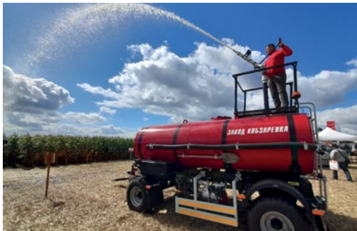
Пожарна цев РС-6. V - 6 м 3 Нанасяне на разтвор с флуид пистолет на разстояние до 30 м
