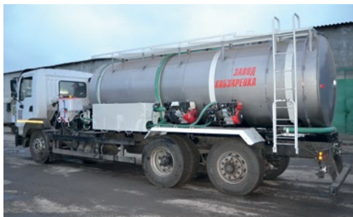
Монтаж на РЗС на шасита на камион
