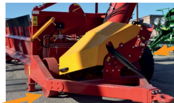
Възможност за допълнителни предни колела за транспортиране на зърно в бункер на БНП машина
