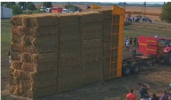
Разтоварени бали на куп бали без използване на допълнително оборудване
