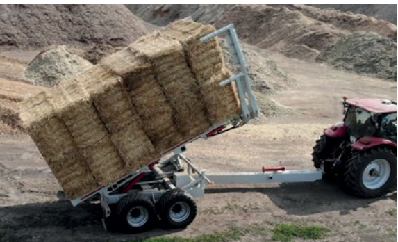
Разтоварването на полуремаркетото за бали върху равна и твърда повърхност отнема 30-40 секунди
