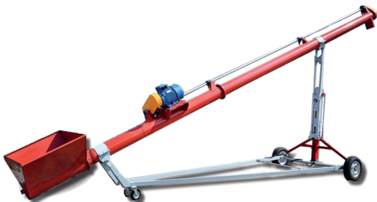
Шнек стационарен SSH-250/12,5 с приемен бункер
