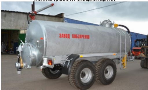
Горещо поцинковане. Поцинковащ слой 100-300 микрона
