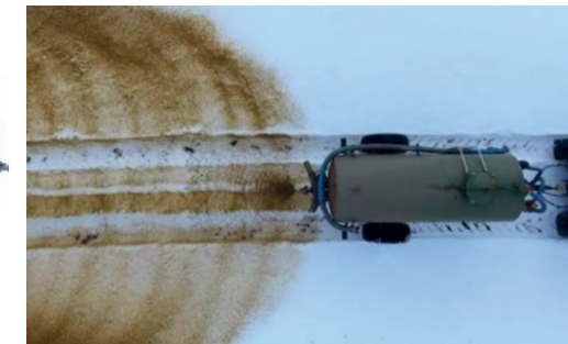
Ежекторен дозатор на сняг
