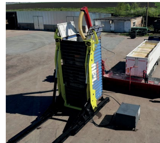
самостоятелно сваляне и слагане на контейнера директно от контейнеровоза
