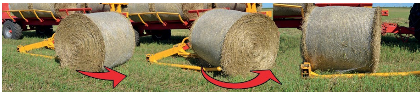
Универсалната хидравлична лапа в движение разгъва ролката и товари на платформата
