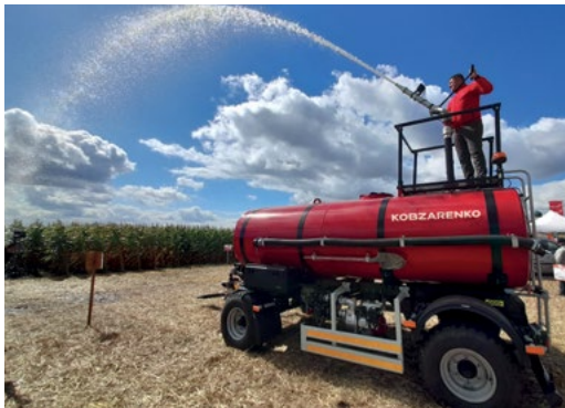
Beczka strażacka PC-6 V o objętości 6 m 3 - podawanie cieczy przez armatkę na odległość do 30 m
