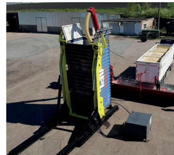
Samodzielnie zdejmuje i instaluje kontener bezpośrednio z podwozia kontenerowego
