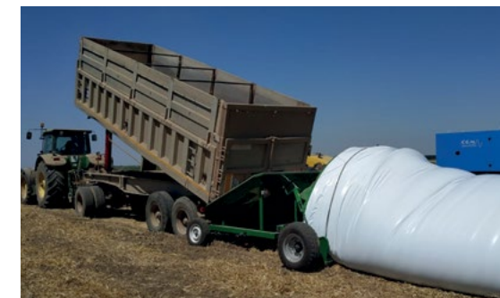
ZPMA-180 z obniżonym koszem przyjęciowym zasilana silnikiem elektrycznym
