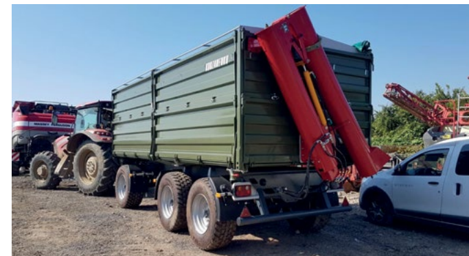
Montaż ślimaków do przyczep ciągnikowych
