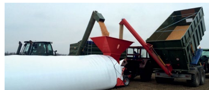
Hydraulicznie rozkładany podajnik ślimakowy GRSH-300/4,5
