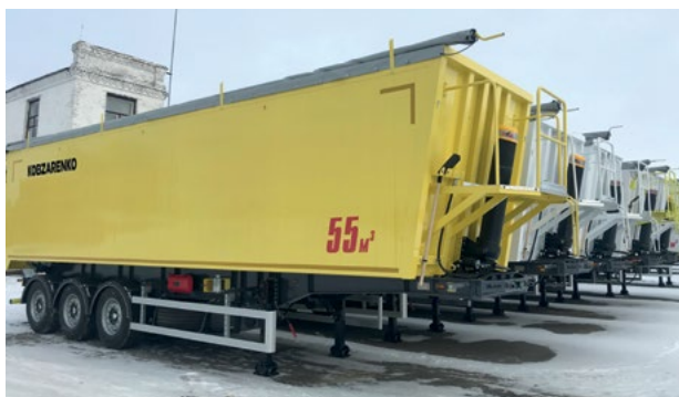
Samochodowa aluminiowa naczepa do przewozu zboża. Modele: 50, 55, 90 m 3
