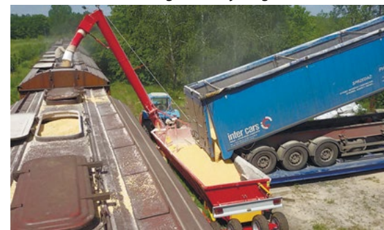
BNP-12 - rozładunek środka transportu ziarna prostopadłe do wagonu kolejowego
