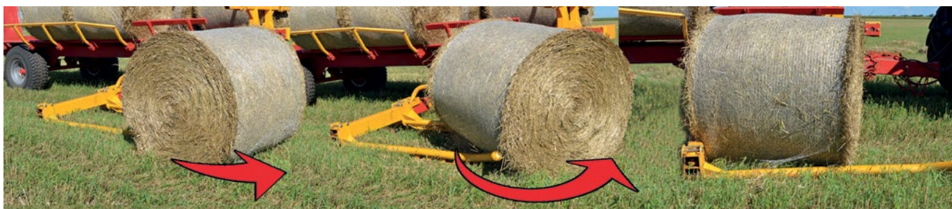
Uniwersalny hydrauliczny chwytak do bel
