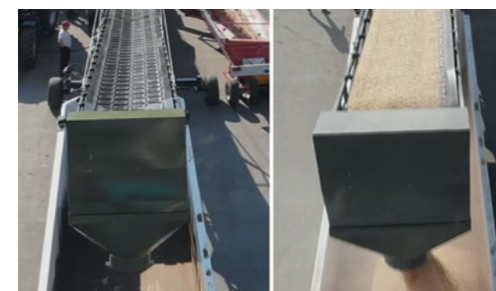
Taśma podajnika w kształcie jodełki
