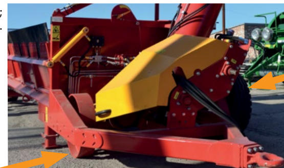
Dodatkowe przednie koła podporowe służą do przemieszczania kontenera wraz ze zbożem
