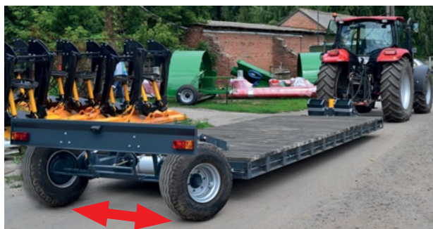
Platforma niskopodwoziowa NP-7 - ładowność – 7 t
