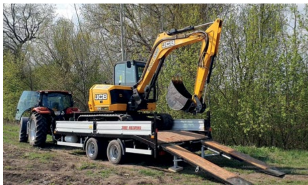
Przyczepa do transportu sprzętu specjalistycznego do 9 ton
