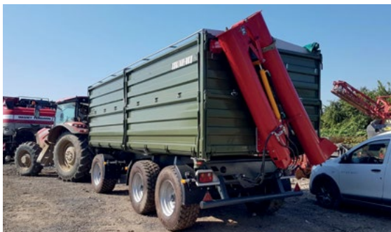
Tylna ściana przystosowana do ślimaka przeładunkowego
