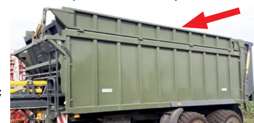
Hydraulicznie otwierana boczna burta -400 mm
