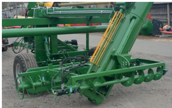
ZRM-180 mit einer zusätzlichen horizontalen Schnecke für die Auslagerung von Mais
