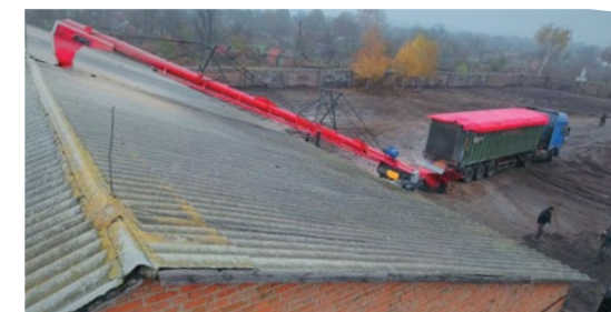
SN-350/22 beim Aufladen von Getreide in das Getreidelager - 3 t/min.
