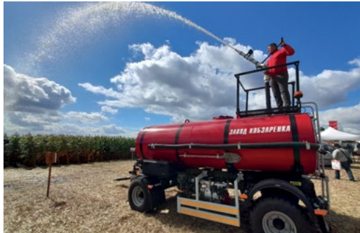
Löschfahrzeug VNC-6/2 V=6m 3 , Reichweite bis zu 30 m, Antrieb durch Zapfwelle oder stationärer Pumpe
