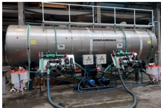
Stationäre RZS 20 Mit zwei unabhängigen Abteilungen
