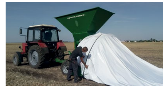
Schlauchbefestigung Ø 2,7 m.
