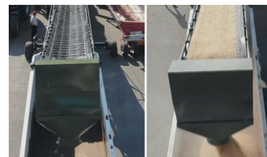
Das 1,200 mm lange V-Förmige Chevron-Band sorgt für einen sicheren Transport des Getreides
