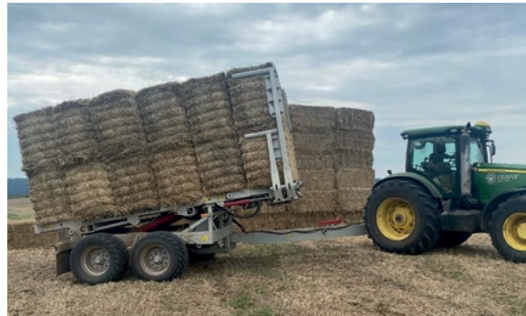
Abladen auf flacher und fester Oberfläche 30 – 40 Sek.
