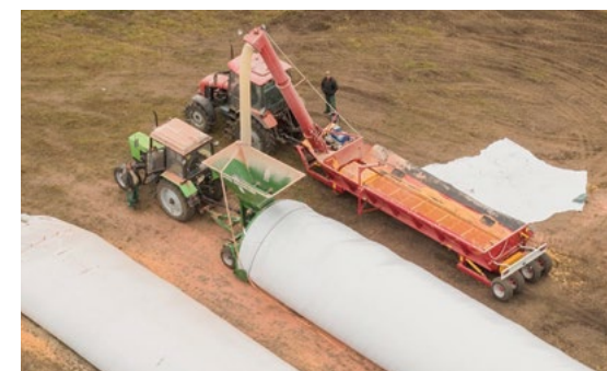
Einsatz des BNP-12 "Kovcheg" für die Einlagerung von Getreide in den ZPM-180
