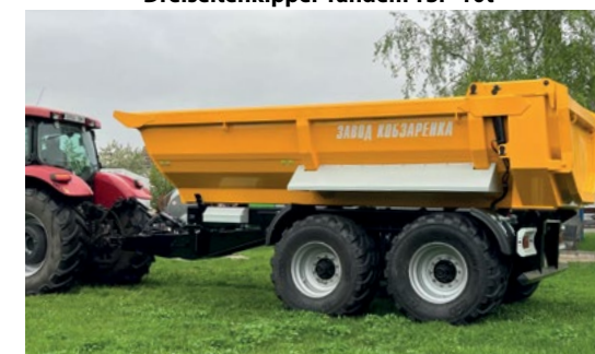
Schwerlastmulde TSP-12 Hardox/BPW Achse
