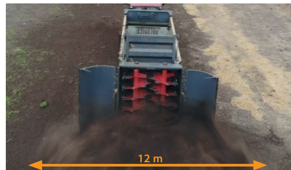
Hydraulische Einstellung der Streubreite bis zu 12 m
