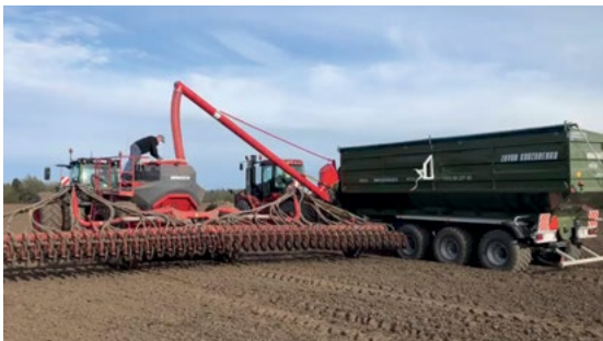
Verlängerte Schnecke (SHRP) zum beladen von z. B. Sämaschinen
