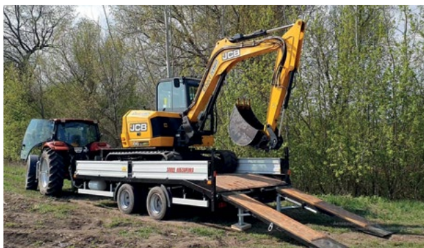
Anhänger zum Transport von Spezialausrüstung bis 9 Tonnen.
