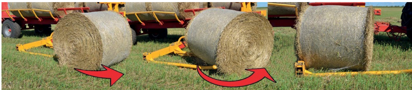
Mit dem Ladearm können die Ballen gedreht und aufgeladen werden
