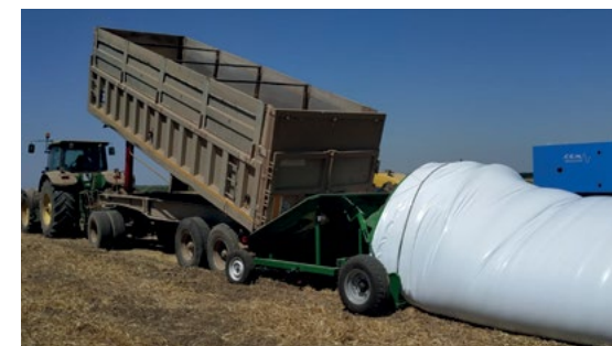
ZPM(A)-180 mit dem niedrigen Bunker und Elektromotor. Beladung von dem Kraftwagen.
