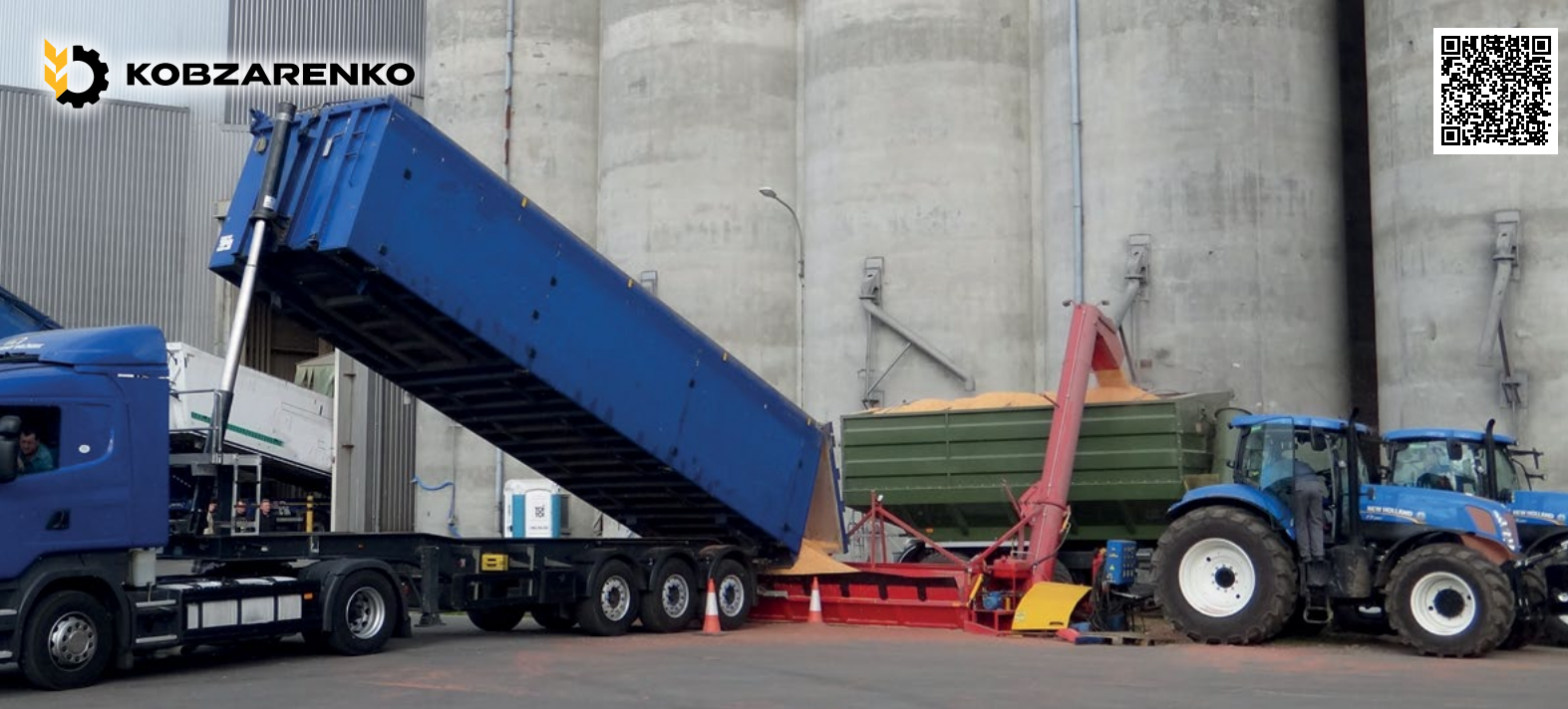
BNP-3 - Be- und Entladung in einem Arbeitsvorgang
