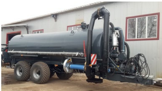
Korrosionsschutzbeschichtung mit Polymerfarben, Hydraulikmischer
