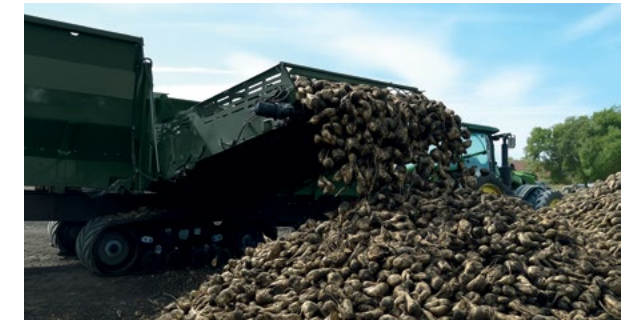
Entladen von Rüben bis zu einer Höhe von 5,8 m.
