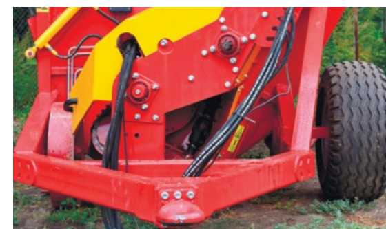
Zusätzliche vordere Räder für die Förderung der Getreide im Bunker
