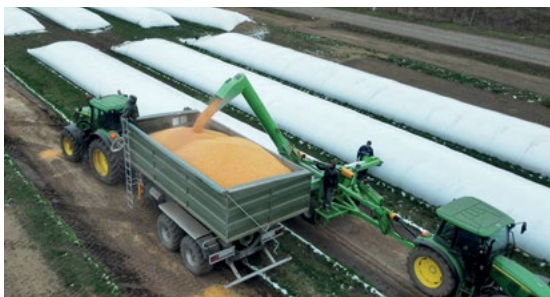
Entladen von Getreide aus dem Sack mit dem ZRM-180
