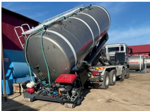
Installation von RZS auf LKW-Chassis
