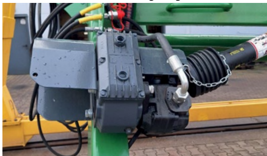
Eigenständige Ölversorgung auf ZRM-180 für die Vergrößerung des Ölflusses im Hydromotor
