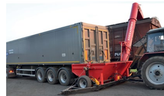
BNP-3 - Be- und Entladung in einem Arbeitsvorgang
