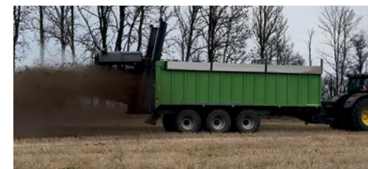
Streuwerk mit Stauschieber
