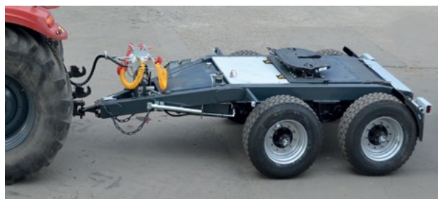
Sattelhänger PSP-20 Dolly Achse (Tandem)
